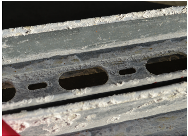
XPG® pinnoitettu MEK®-valaisinkisko suolasumutestin jälkeen.
