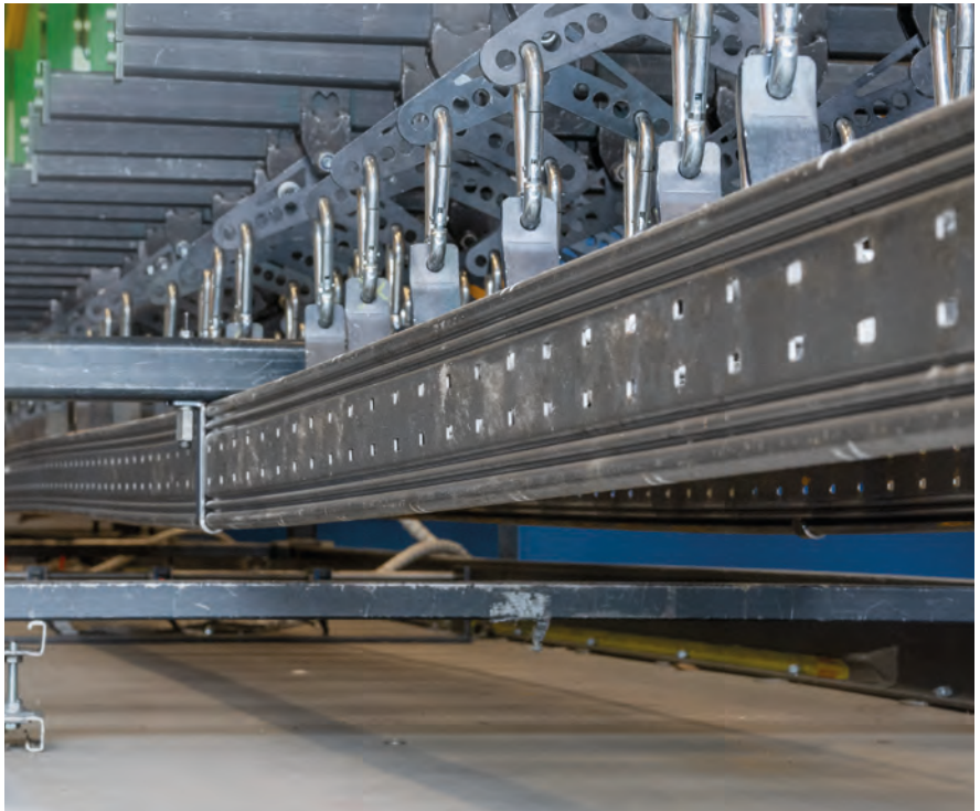
Standardin mukaan testatut tuotteet antavat asiakkaalle mahdollisuuden verrata järjestelmiä keskenään. Kuvassa testataan tikashyllyn turvallista työkuormaa testauslaboratoriomme kalibroidulla testilaitteella.
