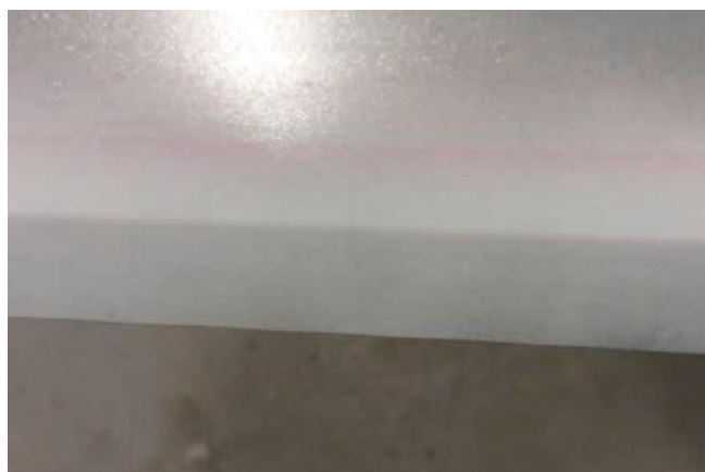
XPG® dengtai POL dugno plokštėi buvo atliktas skysčio praskverbimo bandymas pagal SFS-EN ISO 3452-1 standartą. Įtrūkimų dangoje nerasta.
